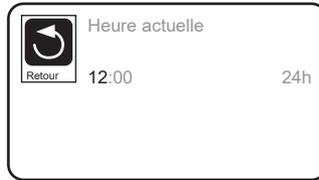
Appuyez sur la flèche de droite pour sélectionner les heures, puis appuyez sur les flèches du haut ou bas pour défiler les heures. Pour passer aux minutes, appuyez sur le bouton de droite. Pour valider revenir sur l'icône enregistrée.
