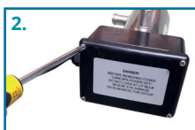
2. Dévissez les 4 vis du boîtier puis retirez le couvercle noir
